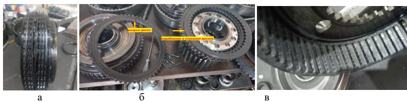
а, б - разрыв фрикционных дисков; в – износ зубьев барабана; Рисунок 2 – Дефекты деталей ведущего вала
