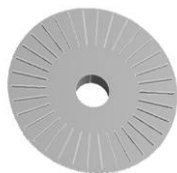
а - Трёхмерная модель рабочего колеса открытого с 34-мя лопатками
