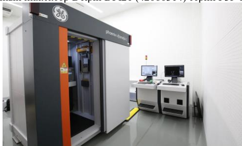
Рисунок 2 – Промышленный компьютерный томограф v/tome/x c450 (измерительный комплекс)
