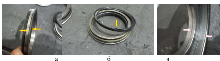
а – износ кольца; б - разрыв кромки резинового уплотнения; в – износ нажимного диска
