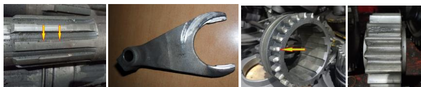
а - износ шлицев вала; б - износ вилки; в – торцевой износ зубьев; г - выкрошивание зубьев
