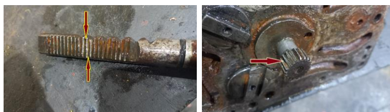
а - поломка зубьев рейки переключения; б – излом шлицев привода рейки
